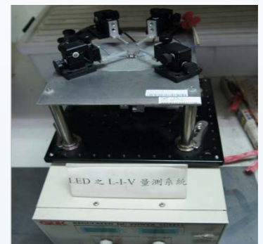
LED L-I-V (亮度-電流-電壓)檢測系統
