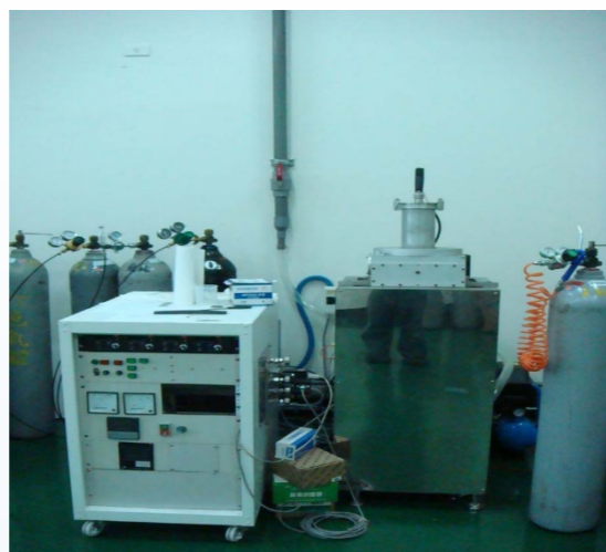
真空高溫CVD鍍膜及退火系統
